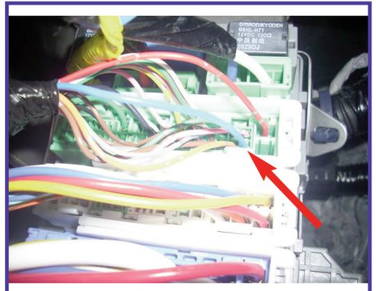
**NEGATIVO :** Per il collegamento elettrico individuare la diramazione di massa originale posta sotto al cruscotto lato guida in alto a sinistra.
