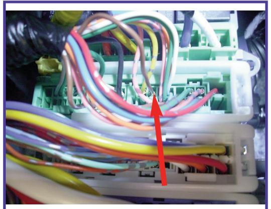
**POSITIVO SOTTOCHIAVE:** Per il collegamento elettrico individuare il filo BLU nel connettore VERDE a 52 poli sul fronte della scatola fusibili fissata sotto al cruscotto lato guida.
