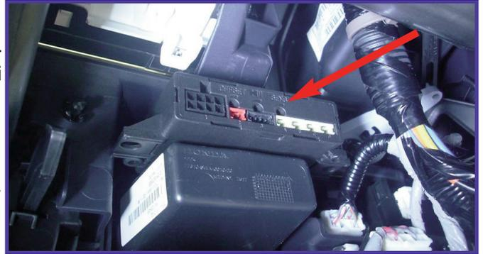
**SEGNALATORE ACUSTICO:** Posizionare il buzzer all'interno dell'abitacolo sulla parte piana inferiore del portaoggetti situato alla sinistra del volante.
